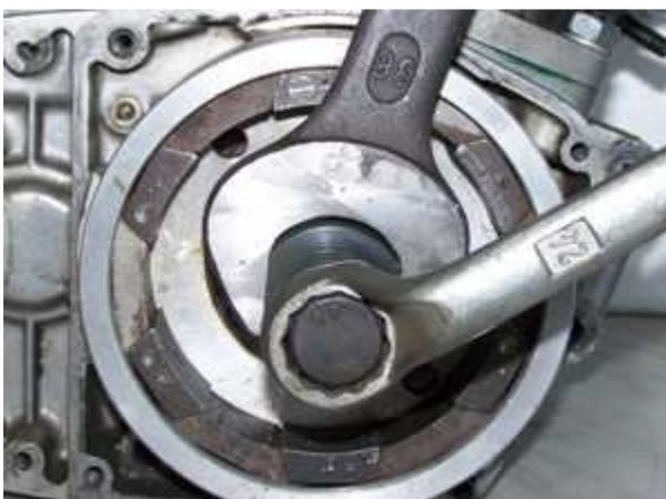
Als nächstes ziehen Sie den Rotor mit einem Abzieher (vermutlich M36x1,5 -**Nicht im Lieferumfang!**-) von der Kurbelwelle.
