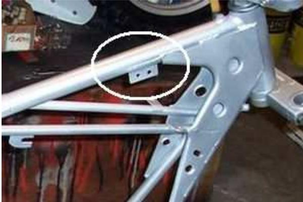
Befestigen Sie nun die neue Zündspule an einem geeigneten Ort. Lassen Sie eine der Halteschrauben der Zündspule noch locker, hier kommt noch ein Massekabel drauf. Verlegen sie den neuen Kabelbaum mit Hilfe der beiliegenden Kabelbinder so am Rahmen, daß es mit den Kabeln auf Höhe der Zündspule endet. Achten Sie darauf, daß nichts scheuern kann.
