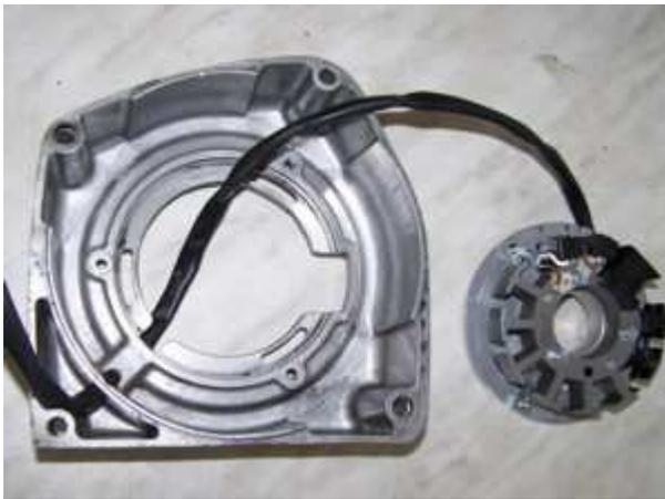
Nehmen Sie die neue Statoreinheit und führen Sie dessen Kabelbaum durch die Kabelführung des Motordeckels. Gehen Sie dabei recht vorsichtig vor, es geht dort sehr eng zu. Eventuell die Isolierung des Kabelbaums etwas einfetten.
