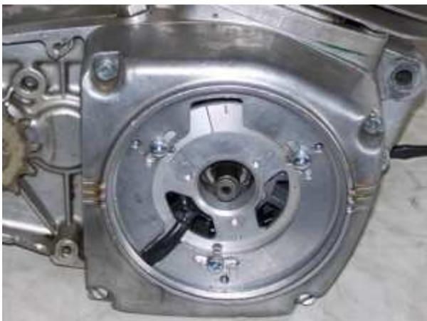
Setzen Sie den Motordeckel mit dem Stator wieder auf den Motor auf. Achten Sie sorgfältig darauf, daß die Sicherungsscheibe der Rotormutter nicht im Stator bzw. der Statorgrundplatte schleift (wie weiter oben schon beschrieben). Dabei den Kabelbaum weiter durch den Kabelausgang ziehen und aufpassen, daß nichts eingeklemmt wird.
