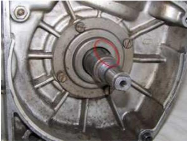
Achten Sie unbedingt auf die Paßfeder auf der Kurbelwelle. Sie wird weiterhin zur korrekten Zündeneinstellung benötigt.
