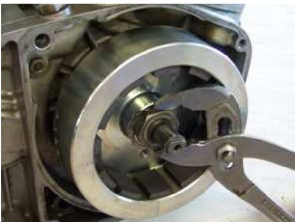
Danach mit einem geeigneten Werkzeug die Sicherungsscheibe über alle 6 Flanken der Befestigungsmutter umbiegen. Bitte die Mutter unbedingt über alle 6 Flanken sichern, da sonst die Scheibe in der Statoreinheit schleift.
