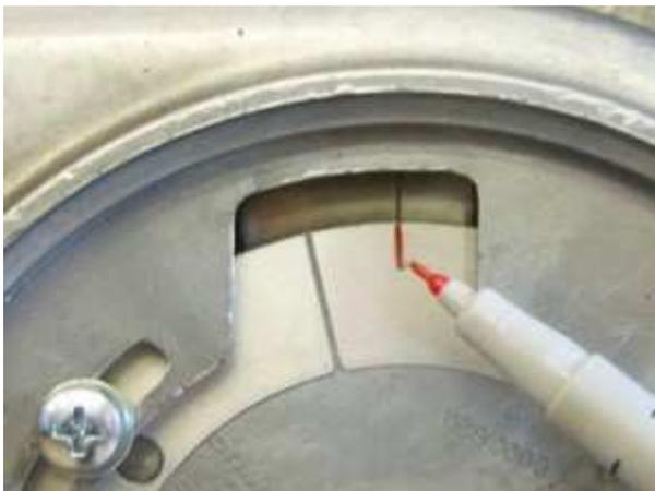
**Zündungseinstellung:** Wenn Sie die Zündkerze noch nicht ausgeschraubt haben, tun Sie dies bitte jetzt. Anschließend bringen Sie den Kolben in Zündposition. Den Wert dafür entnehmen Sie bitte Ihrem Handbuch (wenn keine Werte zur Verfügung stehen, probieren Sie es mit 2mm vor OT). Zum Drehen der Kurbelwelle nehmen Sie am Besten einen 10er Maulschlüssel.
